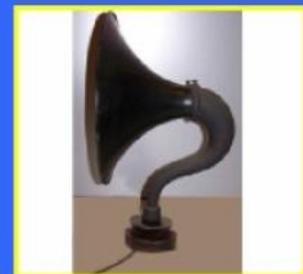
Ein Zweikreiser. Er hatte also im Gegensatz zu den normalen Geräten zwei Schwingkreise. Das brachte eine erheblich bessere Selektion der Sender im schon damals dicht belegten Rundfunkband.
