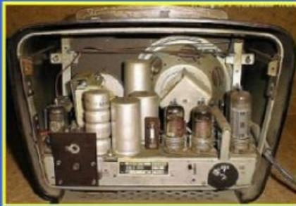
Die Philetta-Modelle wurden über viele Jahre in immer neuen Varianten gebaut. Hier die technischen Daten: Superhet mit den Wellenbereichen LW, MW, KW, 110 und 220 Volt Allstrom. Röhren 5 (UCH42, UAF42, UAF42, UL41, UY41). Kreise 6. Gewicht 3,5 kg. Abmessungen 25 x 21 16 cm.
