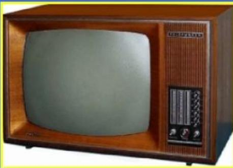
[i.u.] Erster Farb-Fernseher von Telefunken. Das Gerät hatte 14 Röhren und 33 Transistoren und galt als "Strom-Fresser" und Schwergewicht.
