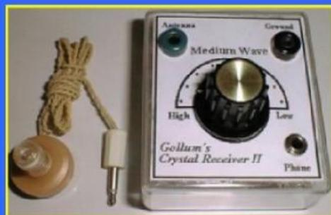
Auch 2015 sind nachts (wegen der MW-Ausbreitungsbedingungen) ausländische Radiosender mitzuhören. Ein solcher Kaufdetektor ist rechts zu sehen. Er wurde von mir noch vor einigen Jahren angeboten. Klein, kompakt und leistungsstark, portabel. Schon einige Meter Antennendraht und ein Draht zur Wasserleitung, zur Zentralheizung oder zur Regenrinne reichten oft für guten Empfang aus.
